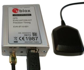
Figura 1 - Ricevitore in singola frequenza u-blox EVK-6T con la sua antenna ANN-MS.
