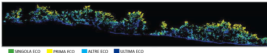
Figura 2 - Sezione trasversale del terreno che evidenzia le eco di ritorno registrate.
