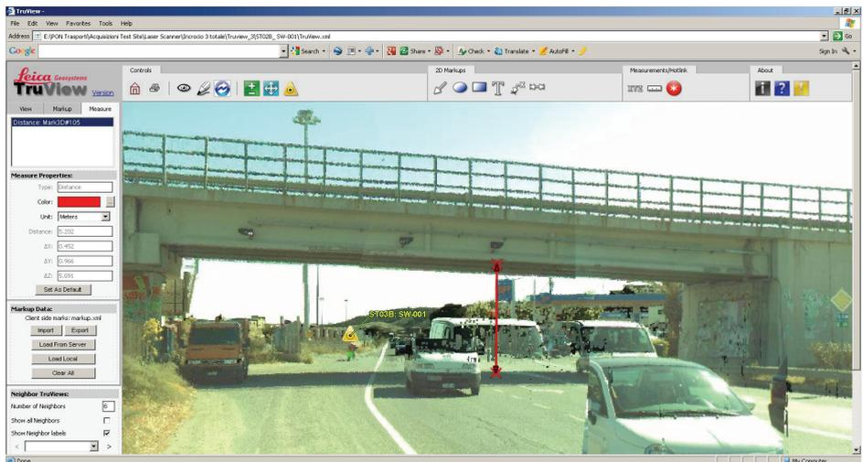
Figura 10 - Vista True View: misura dell'altezza dell'intradosso del sottopasso.
