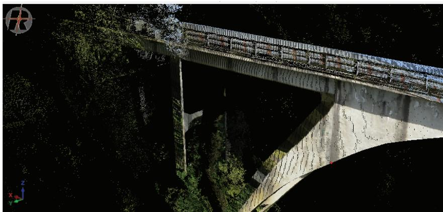
Figura 2 - Ponte Caprovìdi: Particolare nuvola di punti a colori.
