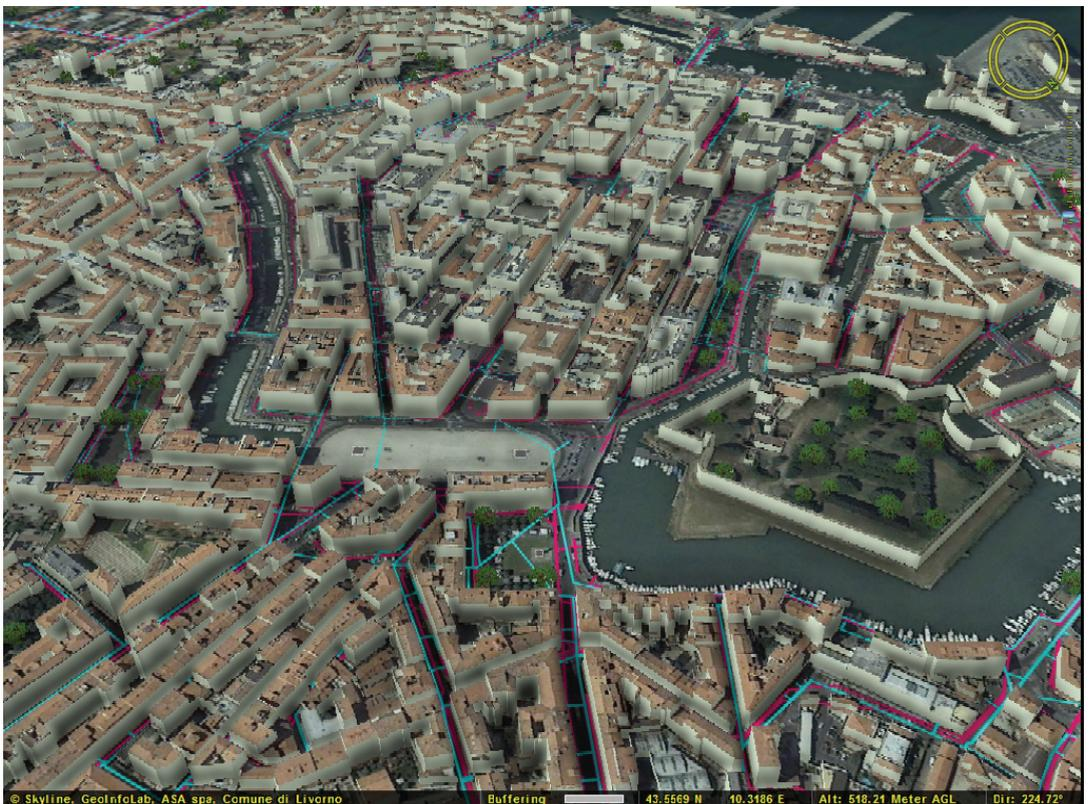
Figura 1 - Distribuzione di acquedotto e fognatura nel centro di Livorno (dati ASA spa e Comune di Livorno, elaborazione GeoInfoLab in ambiente 3D GIS by Skyline).
