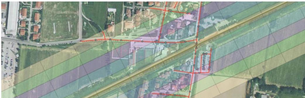
Figura 6 - Calcolo dell'estensione stradale (in rosso) e del punto baricentrico (in verde) all'interno di una cella.
