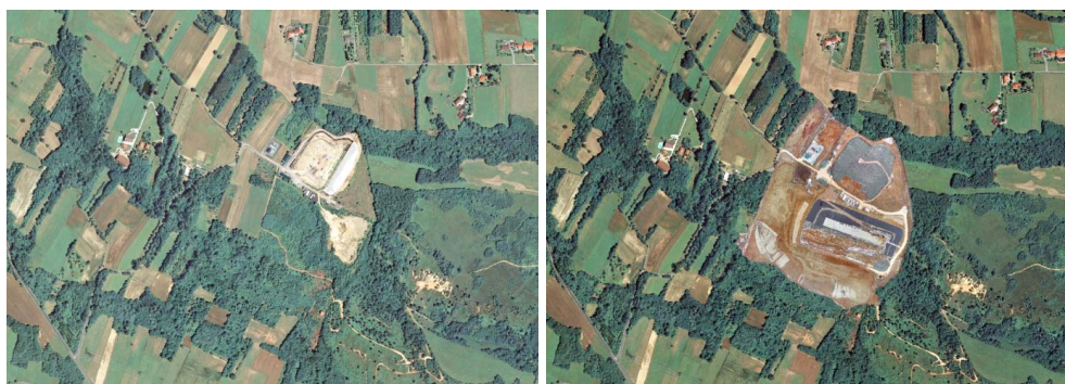
Figure 2 e 3 - Integrazione dati ortofoto: ortofoto esistente dell'area SIA (Grosso - TO-) (sinistra) e ortofoto aggiornata sull'area della discarica (destra). Sono evidenti i cambiamenti del sito, per cui è stata necessaria questa integrazione.
