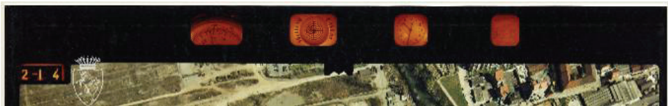
Figura 5 - Esempio di bandella degli strumenti. Nell'ordine, da sinistra: altimetro, bolla sferica e distanza principale della camera, orologio e data del volo.
