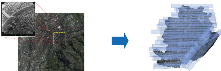
Figura 3 - Generazione del piano di volo.
