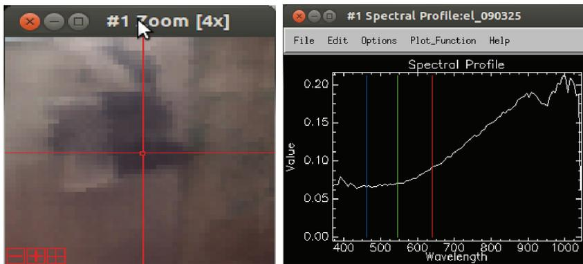
Figura 3 - Firma spettrale acquisita dal CASI per un pixel relativo ad un campione di terreno ricco in SOM.
