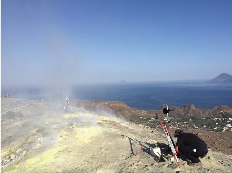
Figura 2 - Misure dirette nel campo fumarolico del cono de La Fossa. Si noti il sistema a prismi in sinistra della fotografia completamente avvolto dalle emissioni acide provenienti dalle fumarole.
