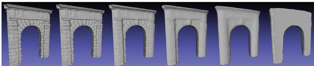
Figura 5 - Modelli geometrici dell'arco con LoD decrescente, da 500.000 a 10.000 triangoli.
