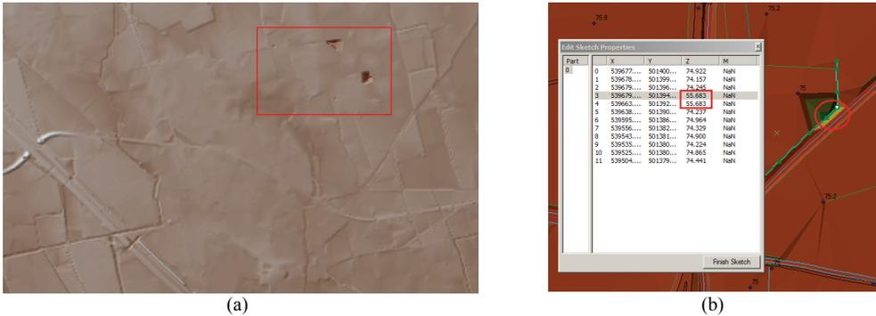
Figura 7 - (a) esempio di quote anomale individuate dall'analisi visuale del DTM con mappa delle ombre; (b) un particolare dell'interrogazione della linea che presenta due vertici con quote errate rispetto al contesto. Sullo sfondo il modello terrain, con le facce triangolari (TIN).
