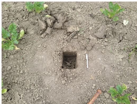
Figura 3a - Scasso praticato nel terreno per l'inserimento della sonda igrometrica.
