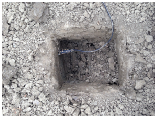
Figura 3b - Sonda igrometrica inserita nel terreno ad una profondità di circa 5 cm dal piano di campagna.
