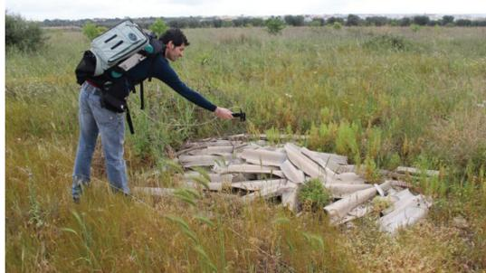
Figura 7 - Acquisizione della firma spettrale dell'amianto per la verità a terra.
