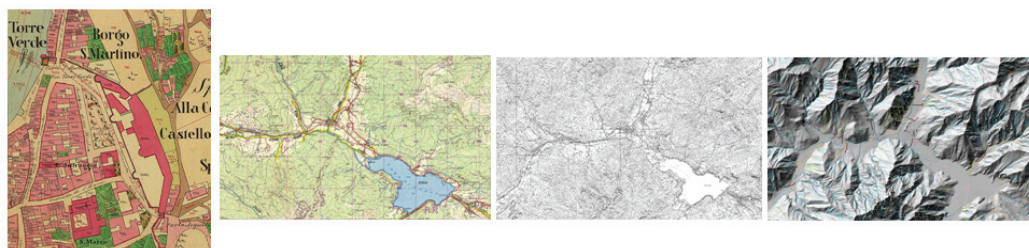
Figura 1 - Rappresentazione del reticolo idrografico: Catasto Fondiario Austro-Ungarico, carta topografica IGM 1:25000, Carta Tecnica Provinciale e DTM su base LiDAR.
