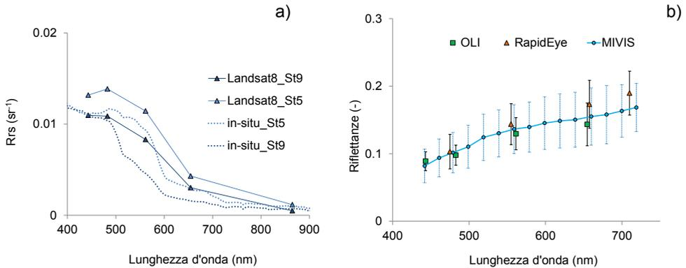
Figura 4 - a) Confronto tra firme di riflettanza misurate in-situ e da satellite (OLI) in stazioni di acqua profonda, b) confronto tra le firme di riflettanza acquisite dai tre sensori in corrispondenza della stessa superficie invariante.
