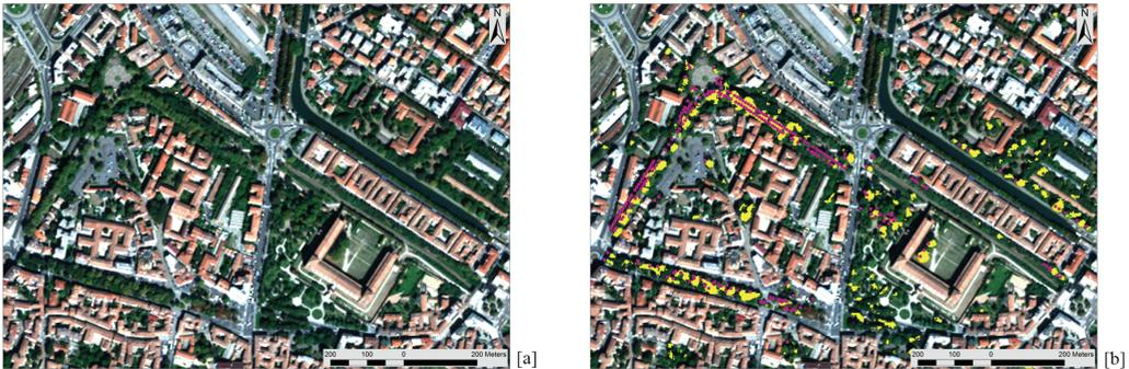
Figura 3 - Esempio di rappresentazione a colori reali di un subset spaziale dell'immagine sintetica a 12 bande [a] e relativo riconoscimento del genere *Platanus spp* [b]. Nell'immagine di destra in giallo il risultato della classificazione pixel-based e in fucsia la campagna a terra GPS relativi al solo genere *Platanus*.
