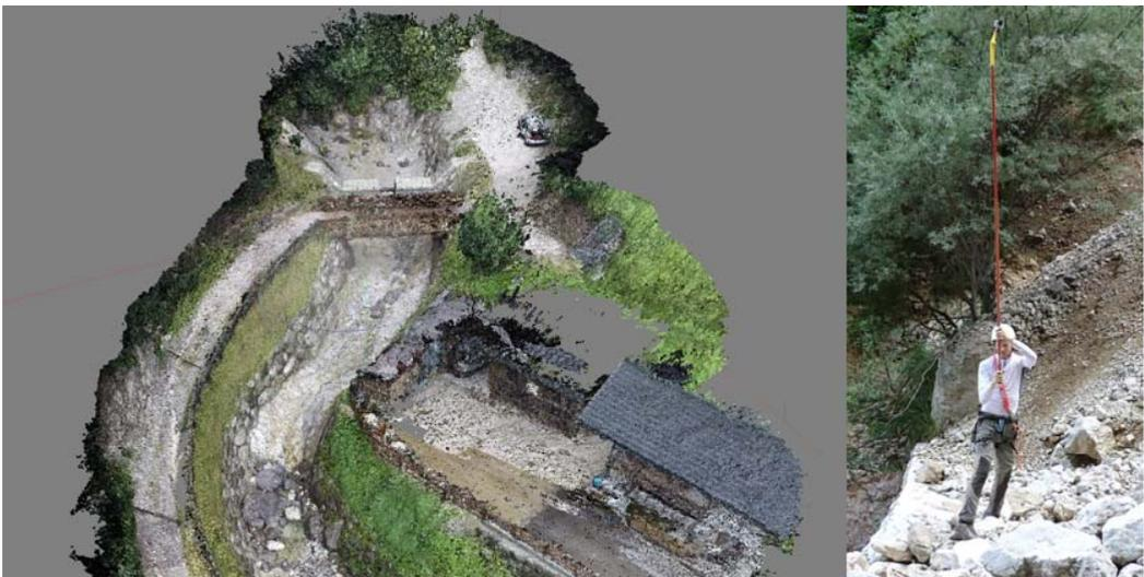
Figura 3 - Esempio di rilievo realizzato con il protocollo di fotogrammetria su attivazione per il rilievo di una briglia danneggiata in un contesto operativamente complesso. Sulla destra il setting operativo con GoPro Hero Silver 3+.
