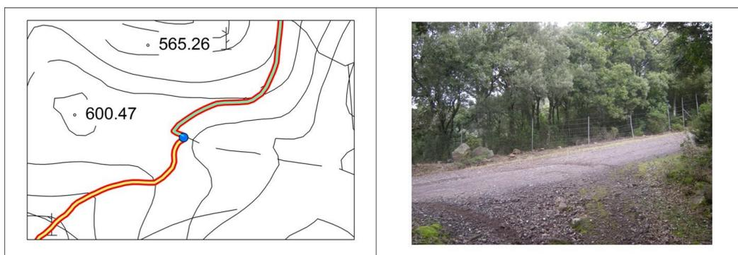
Figura 4 - Segmentazione di tracciati in base a caratteristiche tipologiche (innesto di una carrareccia sterrata con una carrozzabile asfaltata).
