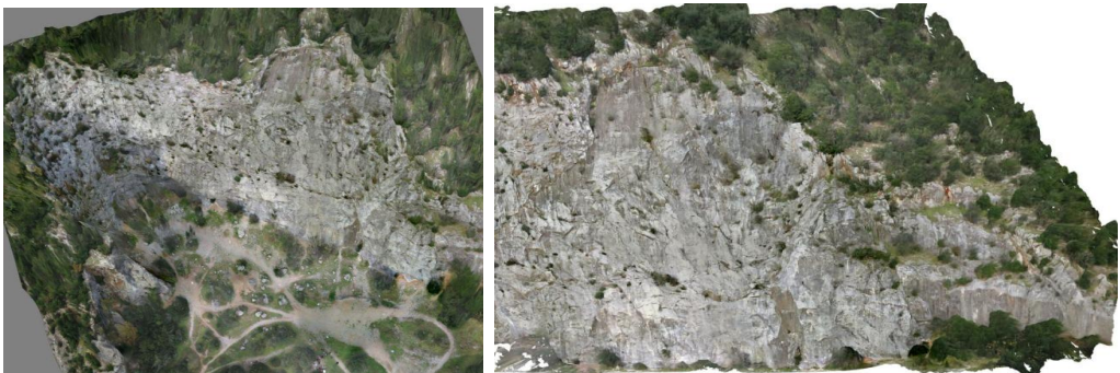
Figure 7 e 8 – Ortofoto con piano di proiezione orizzontale della cava e dell'area antistante (a sinistra) e dettaglio dell'ortofoto con piano di proiezione verticale (a destra).
