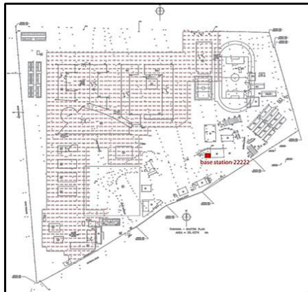
Figura 4 - Area di indagine con identificazione in rosso dei punti di osservazione microgravimetrica.
