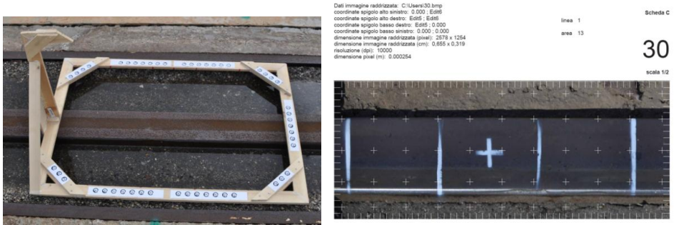
Figura 8 □Telaio fisso con posizionati i targets di orientamento e ortofotopiana.
