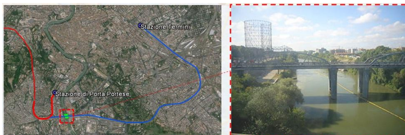
Figura 3 – Tratto urbano a Roma della linea ferroviaria Civitavecchia-Roma. In rosso il tracciato fino alla stazione di Porta Portese. In blu il tracciato fino alla stazione di Termini. In verde e nel riquadro a destra il ponte di ferro del 1863 (elaborazione dell'A.).
