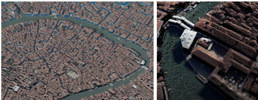
Figura 6 - Nuvola di punti 3D su Venezia con tessitura RGB (sinistra) con dettaglio (destra).
