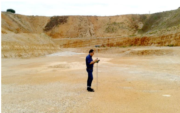
Figura 3 – Fase di acquisizione con ricevitore GNSS.
