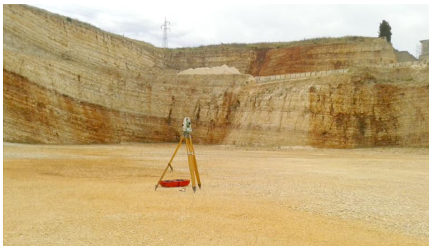
Figura 2 – Stazione totale Leica TPS 1200.
