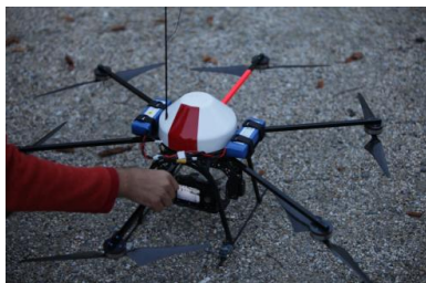
Figura 4 – A sinistra: Hexakopter utilizzato per l'acquisizione; a destra: schema dei due principali voli eseguiti (area dell'anfiteatro in giallo quota di volo 70m, in azzurro quota di volo 30m)
