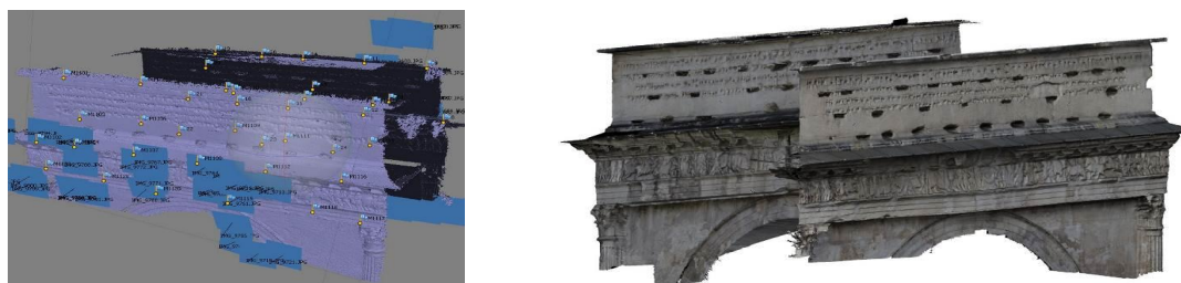
Figura 8 - A sinistra: mesh del fregio elaborata a partire dai dati fotogrammetrici; a destra: mesh del fregio texturizzata con ortofoto estratte dal modello fotogrammetrico.
