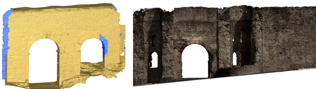
Figura 9 - A sinistra: mesh degli archi dell'acquedotto da dati laser; a destra: mesh del tratto di mura da dati laser texturizzata con dati fotogrammetrici terrestri.
