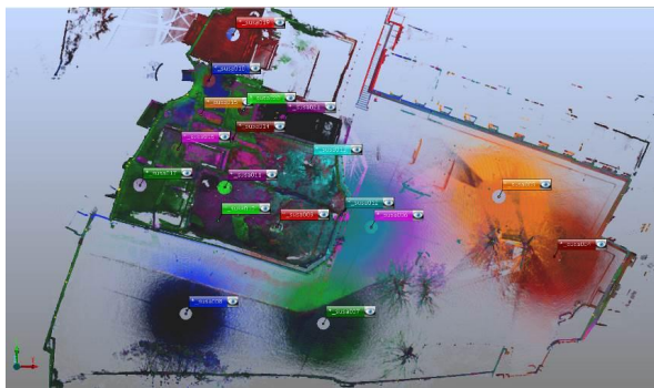
Figura 3 – A sinistra: acquisizione laser eseguita sopra l'acquedotto romano; a destra: visualizzazione della posizione delle diverse scansioni laser effettuate nell'area di scavo e del castello
