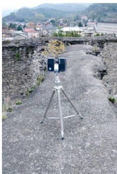
Figura 3 – A sinistra: acquisizione laser eseguita sopra l'acquedotto romano; a destra: visualizzazione della posizione delle diverse scansioni laser effettuate nell'area di scavo e del castello
