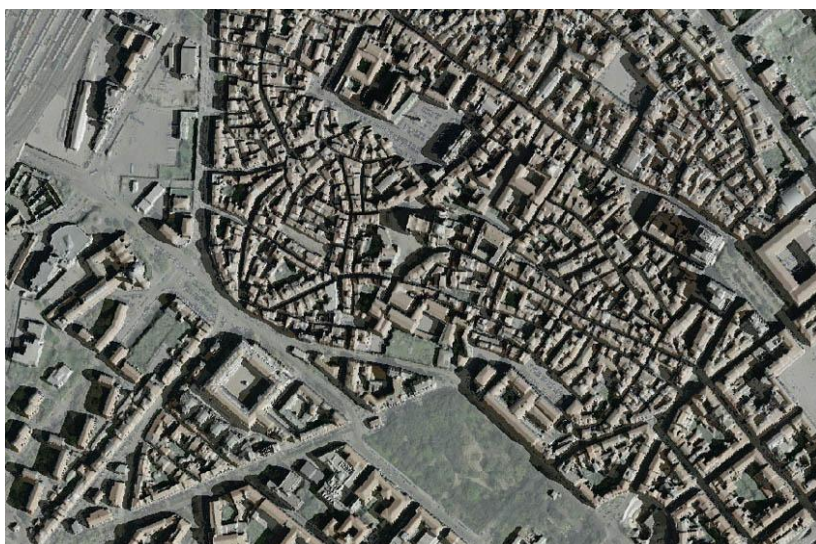
Figura 3 - Esempio di simulazione delle ombre relativa al giorno 22 aprile alle ore 10. Elevazione del Sole 37,1^\circ , Azimuth 107,53^\circ (centro urbano di Sassari).
