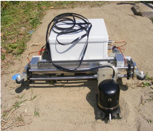
Figura 4 - Radar olografico in scansione e schema a blocchi della piattaforma
