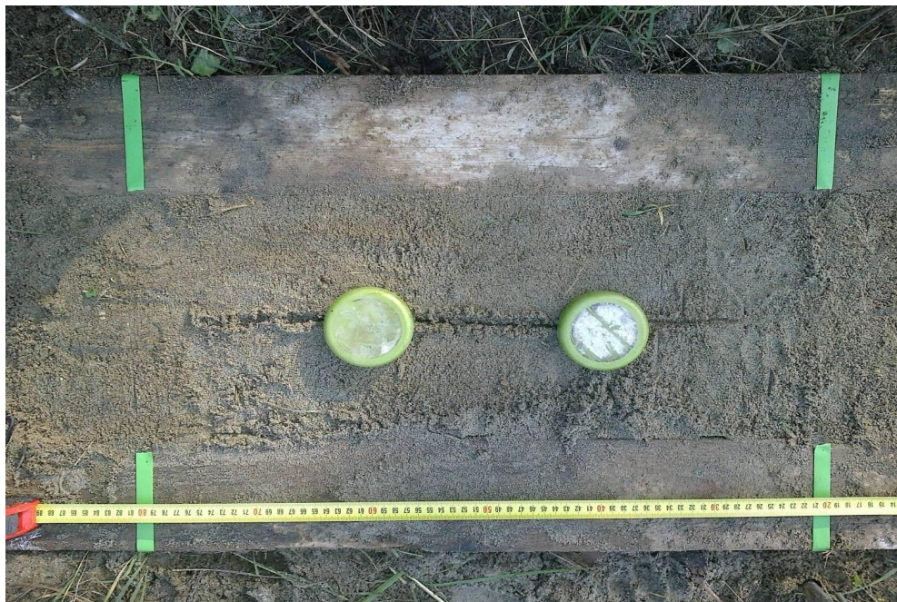
Figura 5 - Esempio di mine campione in plastica prima dell'interrimento
