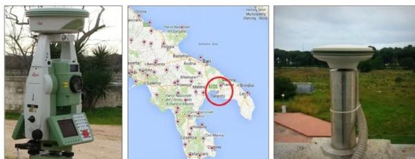
Figura 2 □ Strumentazione topografica Leica Smart Station e Stazione Permanente GNSS TARA.
