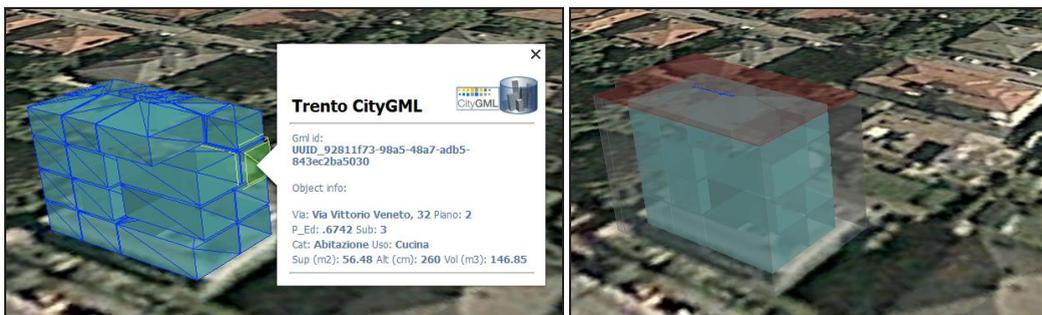
Figura 6 – A sinistra: visualizzazione del modello 3D dell'interno dell'edificio, ottenuto da dati Docfa 4. A destra, visualizzazione integrata dell'esterno (da dati topografici) e dell'interno dell'edificio (da dati Docfa).
