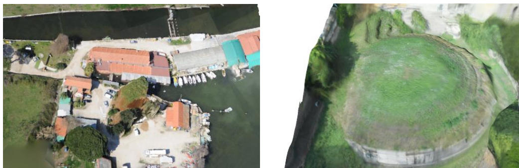
Figura 1. La stessa procedura di rilevamento fotogrammetrico, eseguita a quote diverse da aereo (a sinistra) e con micro-drone (a destra), consente di produrre con le stesse tecniche di elaborazione modelli 3-D a scala più ampia nel primo caso e maggiormente ravvicinata nel secondo. Benché gestibili attraverso gli stessi apparati informatici, le due riprese corrispondono a due livelli di analisi concettualmente diversi dal punto di vista geografico. Il modello a sinistra si riferisce ad un gruppo di strutture lungo il Porto Canale di Paola, quello a destra al Mausoleo di Lucilio Peto a Roma. Entrambi presentano le condizioni attuali di strutture risalenti all'età romana.
