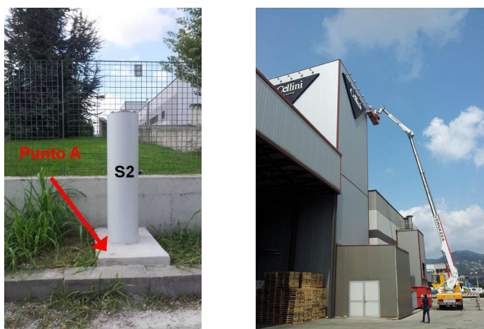
Figura 2. Esempio di pilastrino monumentato e operazione di posizionamento dei target sulla torre di Cellini Caffè.
