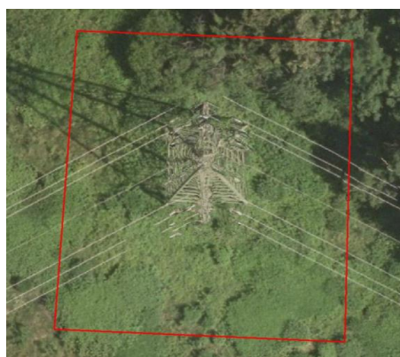
Figura 9. Errori delle ortofoto di precisione dovuti a errori nel matching. Sinistra: tetti in vetro; destra: tralicci della corrente elettrica. Copyright Stadt Graz.
