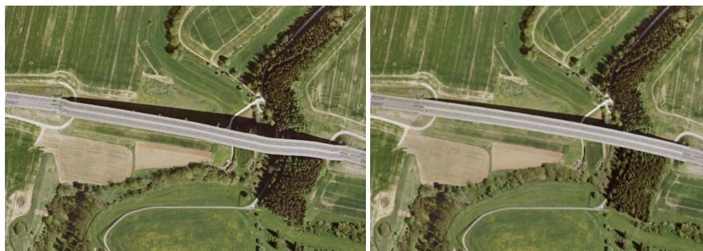
Figura 3. Esempio di errore nella fase di ortorettifica dovuto al modello digitale del terreno (sinistra) e successiva correzione manuale (destra).
