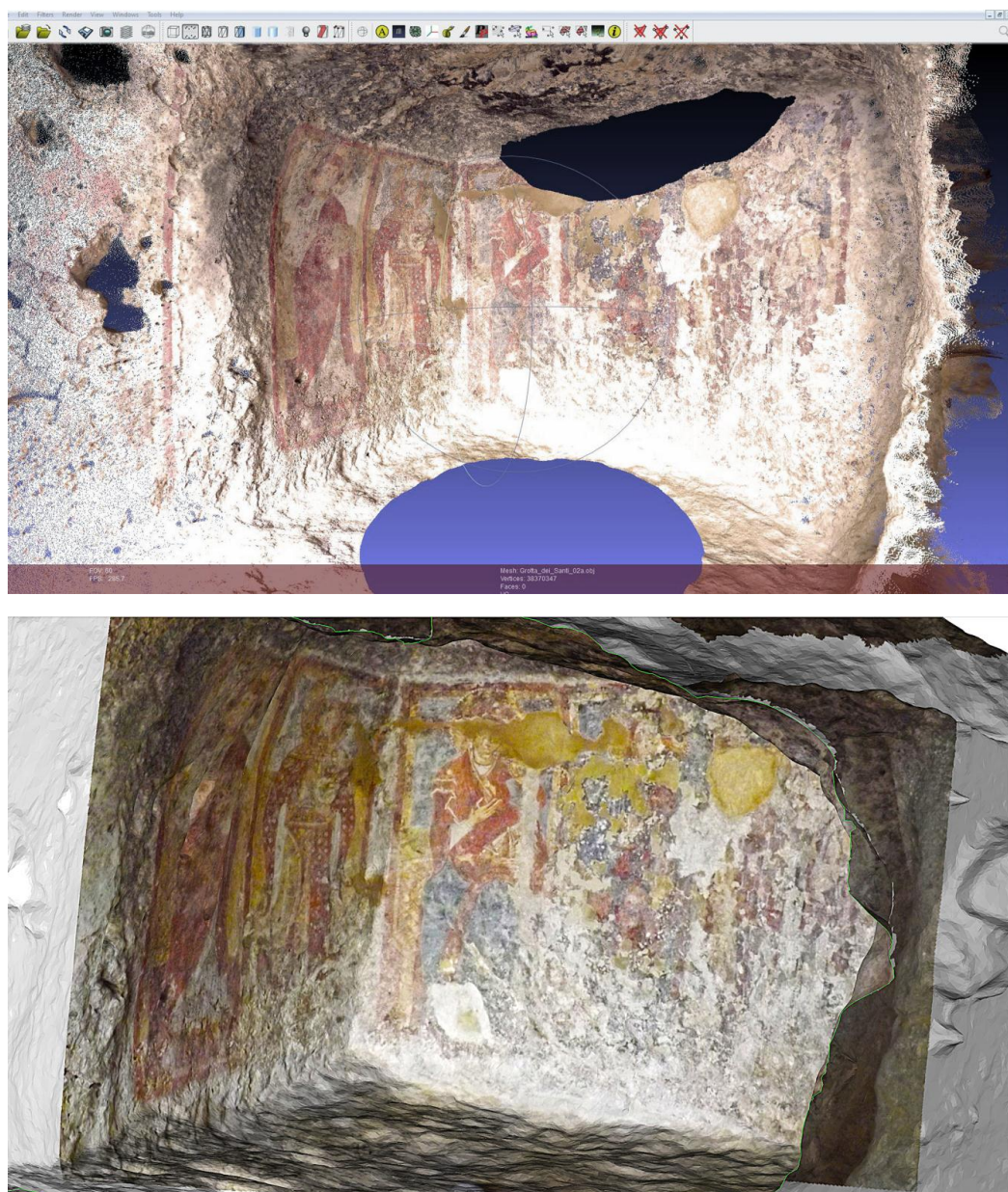
Figura 6. Confronto tra nuvola di punti e modello poligonale con riproiezione delle immagini.
