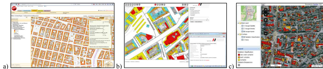
Figura 2. Esempi di catasti solari disponibili su web e caratterizzati da diversi approcci di rappresentazione dei dati: rasters riclassificato dell'irradianza solare mappata sul catasto cittadino (Vienna – a), falde vettoriali colorate con i valori medi di irradianza solare (St. Gallen – b), raster riclassificato del potenziale fotovoltaico sovrapposto all'ortofoto cittadina (Bressanone – c).
