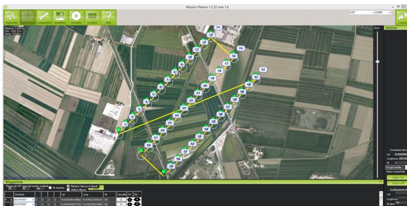
Figura 4. Esempio su Arduplane dove ogni centro di prese costituisce un waypoint.
