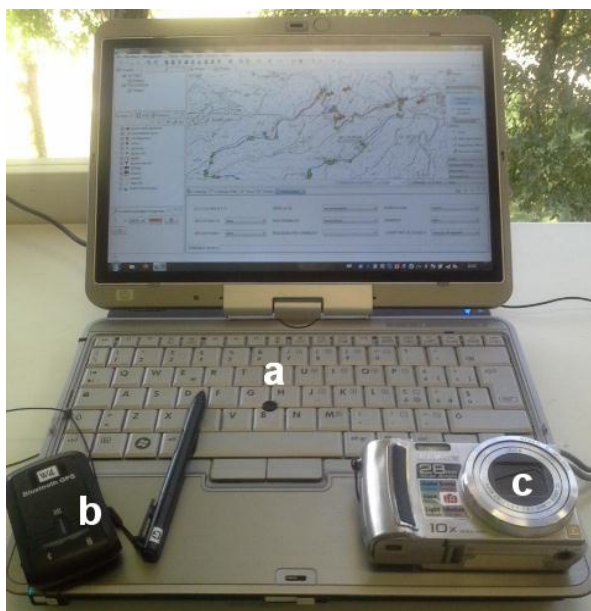
Figura 2. Strumenti di rilevamento: a) tablet PC con mobile-GIS; b) ricevitore GPS; c) fotocamera digitale.
