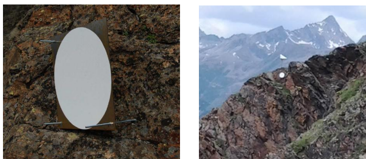
Figura 5. Punto di controllo TLS (sinistra); esempio di configurazione combinata dei reference point per le tre tecnologie (riflettore artificiale SAR con innesto per il sensore GPS e punto di controllo TLS) installati in maniera solidale su un blocco di roccia omogeneo e stabile, (destra).
