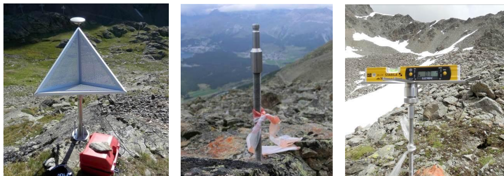
Figura 4. Riflettore artificiale e antenna di una “Base station” della rete GPS (sinistra); Caposaldo (centro); strumento di valutazione della rotazione dei blocchi (destra).
