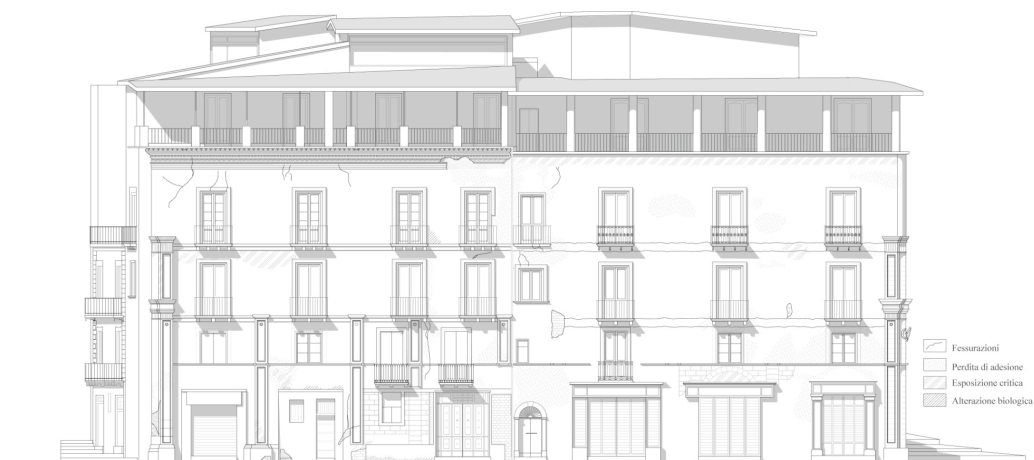
Figura 7. Stato di degrado del prospetto principale.
