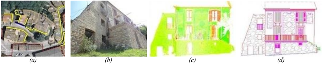
Figura 7. Rilievo fotografico/laser scanner per l'Unità Strutturale 6A: a) posizione nell'aggregato; b) rilievo fotografico; c) nuvola di punti; d) restituzione grafica.
