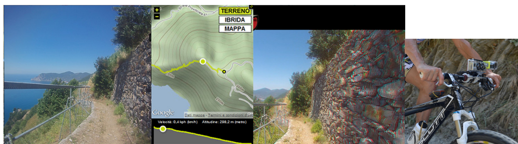
Figura 6. Esempio di coppia di immagini tratte da video 3D e relativa localizzazione geografica. Il manubrio di una mountain bike equipaggiato con il sistema stereo 3D go-pro e ricevitore GPS.
