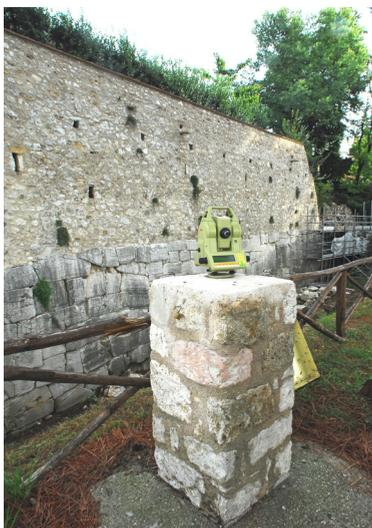
*Figura 1. Stazione su pilastro per il monitoraggio delle mura di Amelia.*
