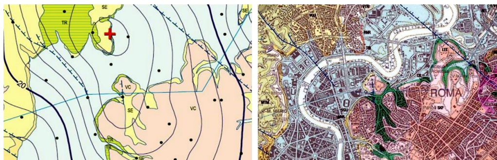
Figura 1. Confronto alla stessa scala dei dati sulla carta gravimetrica e su quella geologica, attraverso lo stralcio del foglio n. 374 Roma Gravimetrico (a sinistra) e Geologico a destra.
