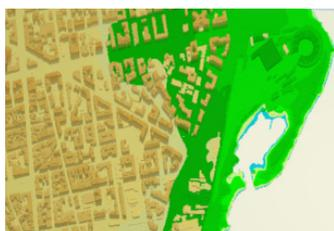
Figura 6. DTM LiDAR con edificato estruso.
