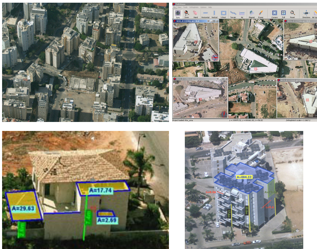
Figura 3. Gestione e misura degli oggetti all'interno del software "Multivision".
