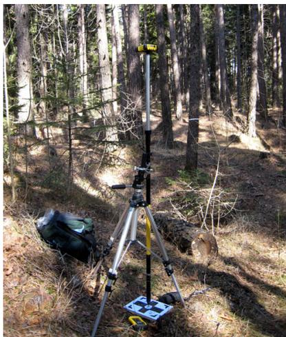
Figura 2. La configurazione GPS usata per il rilevamento dei GCP.
