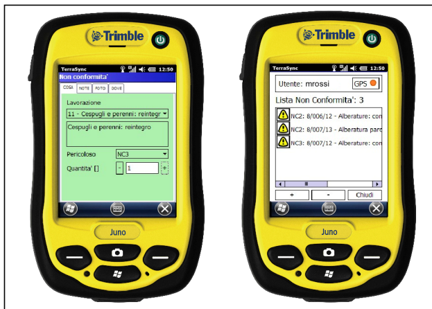
Figura 4. Palmari Trimble JUNO con l'applicativo per il rilievo delle non conformità.
