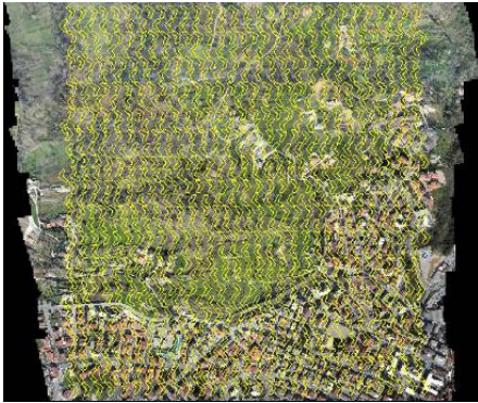
Figura 8. Orientamento di tutte le immagini effettuato in Bundle Adjustment dal software APS. Figura 9. Collimazione dei GCP e residui sui punti.
