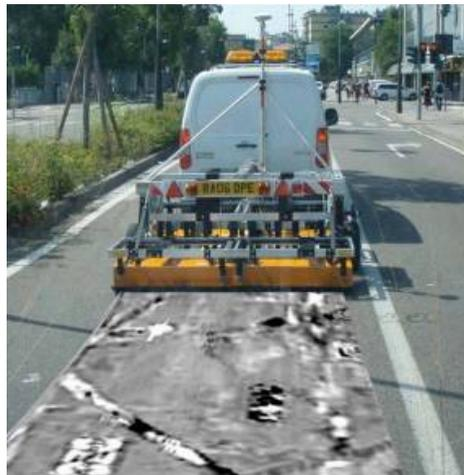
Figura 3. Sistema IDS Stream a quattro banchi, per un totale di 38 canali attivi, montato su carrello trainato da furgone durante la scansione di Via Torino.
