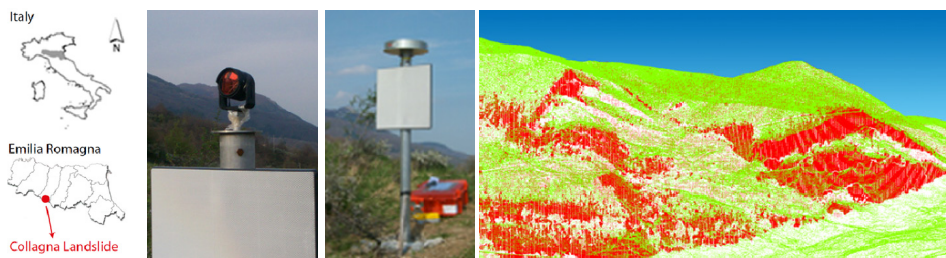
Figura 1 – Da sinistra: localizzazione della Frana di Collagna; punto di controllo RIF1 (palo infisso nel terreno con dispositivo a centramento forzato): prisma per stazione totale e target fisso per LST ; punto di controllo RIF1: punto GPS e target fisso LST; nuvola di punti LIDAR (Aprile 2010) dall’integrazione dei rilievi terrestri, in rosso, e aviotrasportato, in verde.
